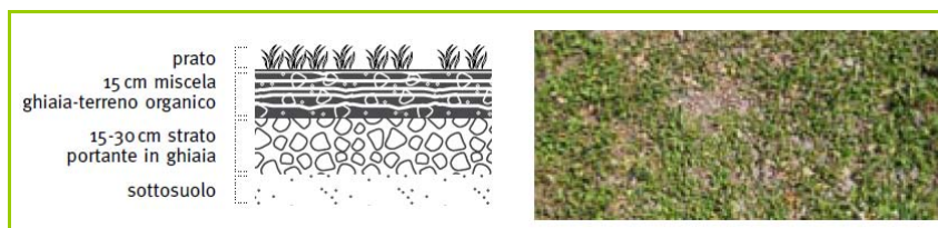
Figura 30 – Sezione di dettaglio ed esempio di sterrati inerbito
